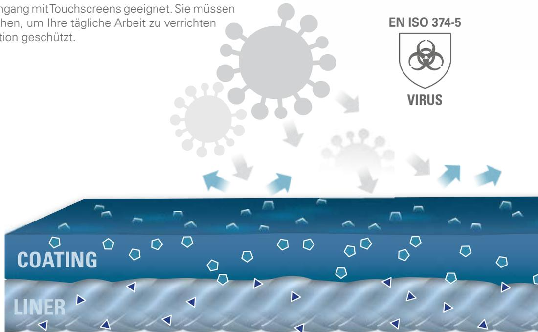
Schematische Darstellung des Handschuhquerschnitts – stark vergrößert
